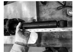
サスペンション構成部品を計測した結果、曲がり や変形が発生している場合は機能が発揮できない ため取替と判断する
