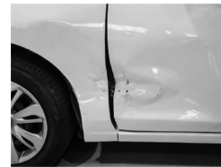
フェンダ及びドアに局所的な潰れ・折れが発生し ており修理が困難と判断した例
