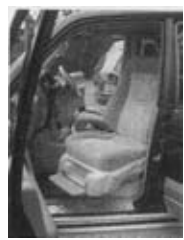
▲写真6 作動時1（助手席シートが回転）
